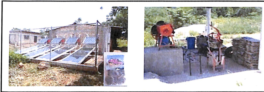
Fotografía 6. Deshidratadora de frutas Xuxú Muxatej y Bloquera del CECYTeN. Fuente: propiedad de la autora
