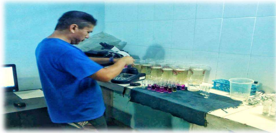
Figura 2. 6 Análisis de compuestos nitrogenados y fósforo en el agua del cultivo de camarón.
