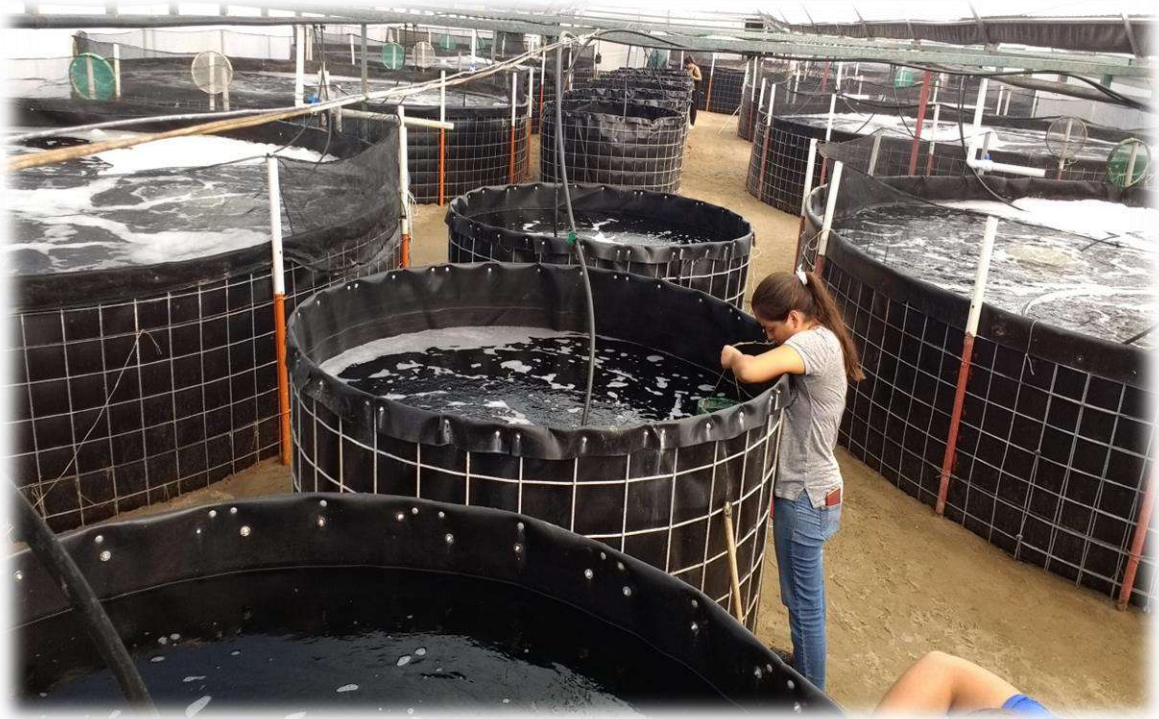
Figura 1. 2 Geomembranas de polietileno de alta densidad (HDPE), utilizadas para el cultivo de camarón.
