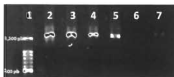
Figura 18. Electroforesis en gel de agarosa al 1 % de los productos de PCR. Carril 1: marcador de peso molecular (MPM) 100 pb. Carril 2: ADN cepa 4. Carril 3: ADN cepa 12. Carril 4: ADN cepa 16. Carril 5: ADN cepa 81. Carril 6: control negativo (-ADN). Carril 7: control positivo.
