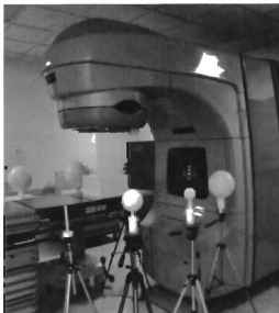
Fig. 20.- Arreglo experimental para medir fotoneutrones en modo planetario
