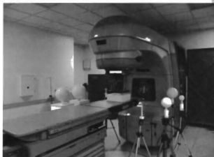
Fig. 21.- Arreglo experimental para medir electroneutrones en modo planetario
