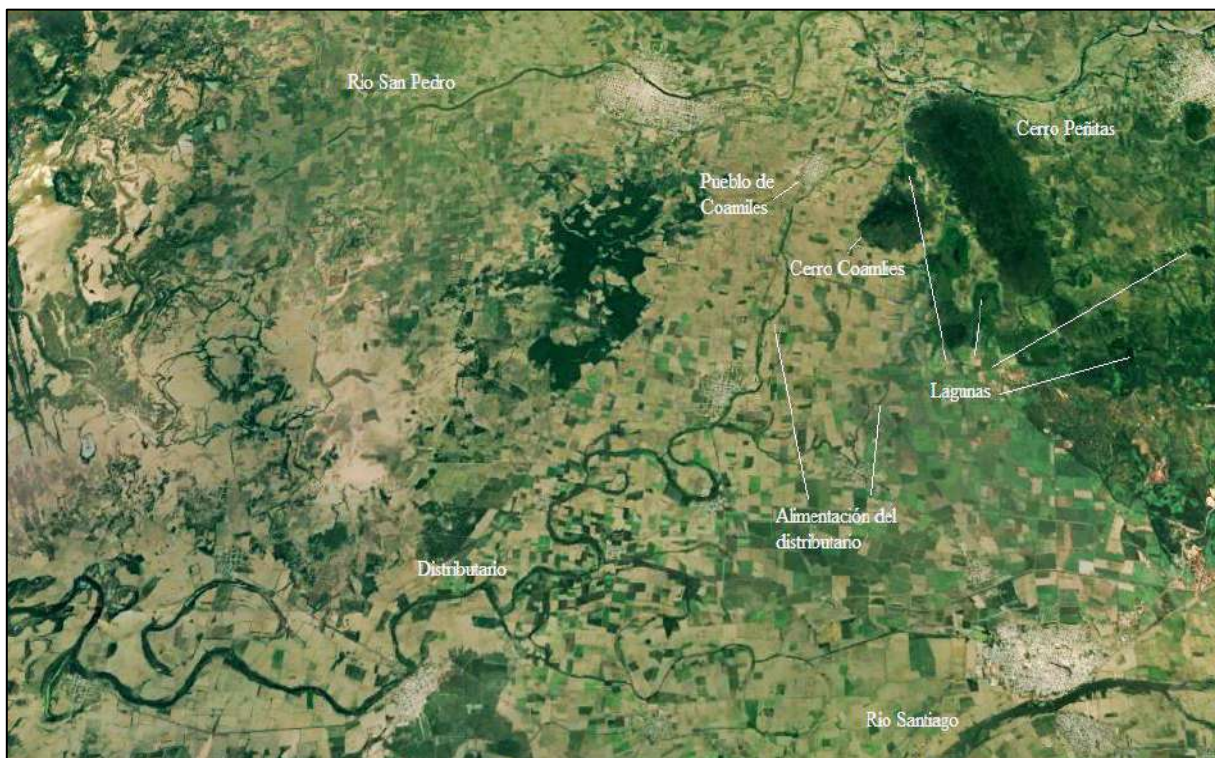
Figura 16. Distributario señalado como el antiguo cauce del río Santiago, nótese que es alimentado por las pequeñas lagunas, representa una zona de alto riesgo por inundación.
