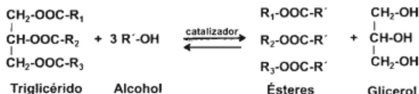
Fig. 2. Esquema general de la reacción de transesterificación.
