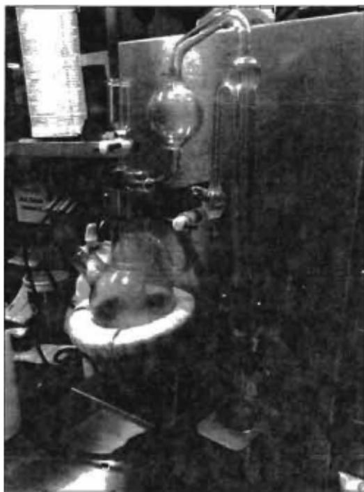
**Figura 9.** Equipo de destilación de micro-kjeldahl.
