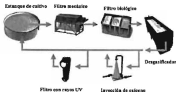
Figura 3. Esquema general de un sistema de recirculación de agua (SRA). Los componentes básicos son el filtro mecánico, el filtro biológico y el desgasificador (FAO, 2015).
