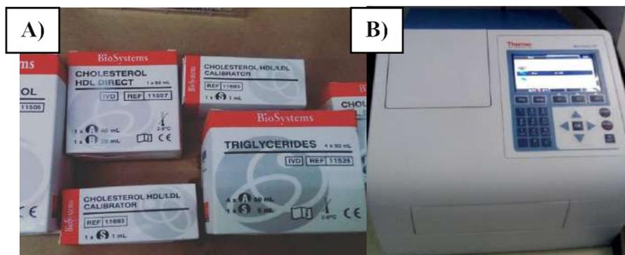
Figura 22. A) Kits comerciales utilizados para la determinación de colesterol total, HDL, LDL y triglicéridos y B) fotómetro de multiplaca.
