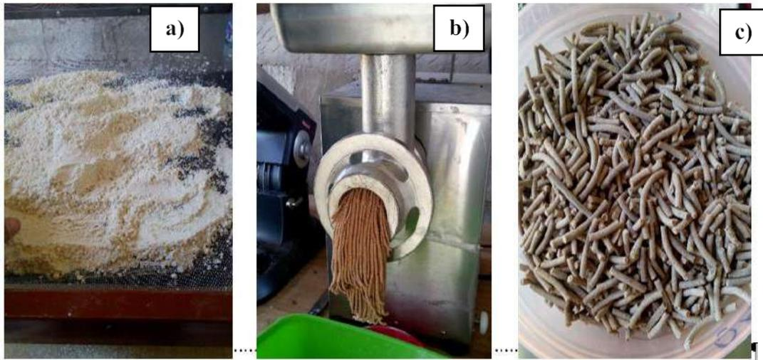
Figura 12. Proceso de elaboración de las dietas: a) tamizado post-molienda de ingredientes secos, b) proceso de extrusión con un molino de carne (Tor Rey, México) y c) pellets secos de 2 mm de diámetro.
