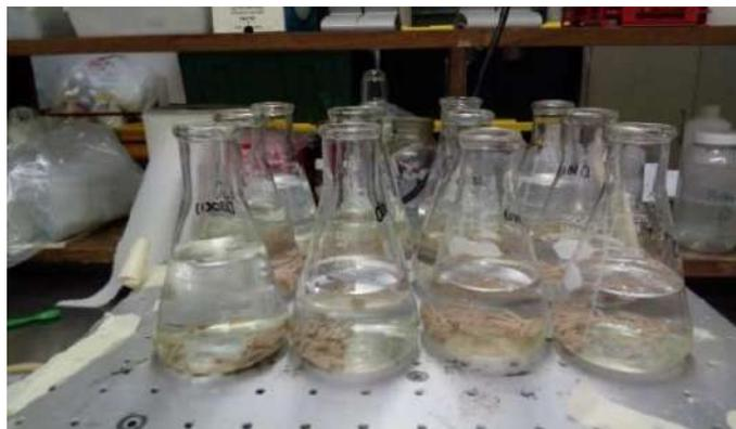
Figura 14. Determinación de estabilidad de las dietas experimentales (modo de agitación de las dietas en agua destilada en agitador horizontal).
