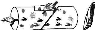
Fig. 4.- Esquema del dispositivo excludor de tortugas Super Shooter y posición de trabajo en la red camaronera. Fuente: Villanueva-Talavera (1997).
