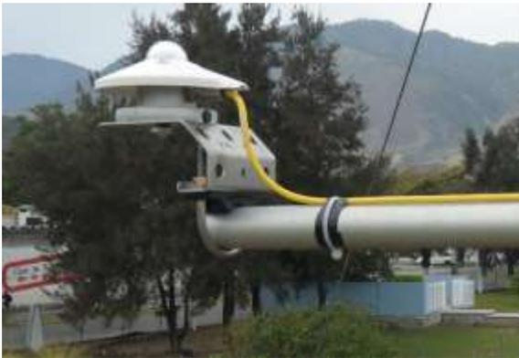
Figura 2 Piranómetro Kipp and Zonen CMP3 instalado en la estación anemo-solarimétrica de la UAN, utilizado para la evaluación del recurso solar en la ciudad de Tepic.
